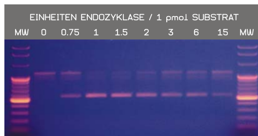
Fig. 3: Prozessierung eines 1 kb PCR-Amplikons in zwei 500 bp DNA-Tochterfragmente mit einseitig kovalent verbundenen Enden. Die Effizienz der Endozyklase N15 – Prozessierung ist stark abhängig von der Menge des eingesetzten Enzyms. Optimale Ergebnisse werden mit 1 U Endozyklase N15 je pmol Substrat erzielt.
